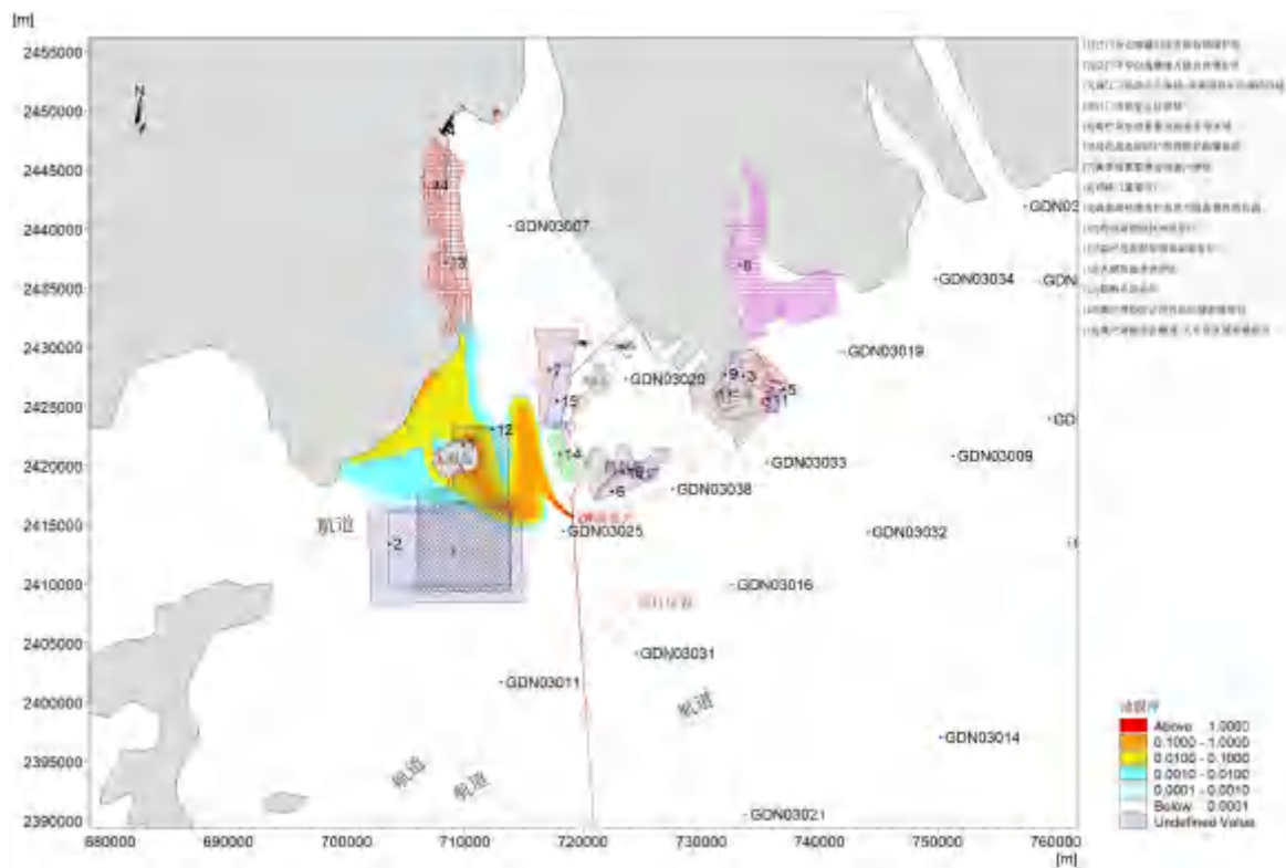
图 8.5-3a 2#点溢油事故的油膜运动轨迹图 (大潮涨潮期, 风向 SE, 风速 3.7m/s, 油膜绘制时间间隔 30min)
