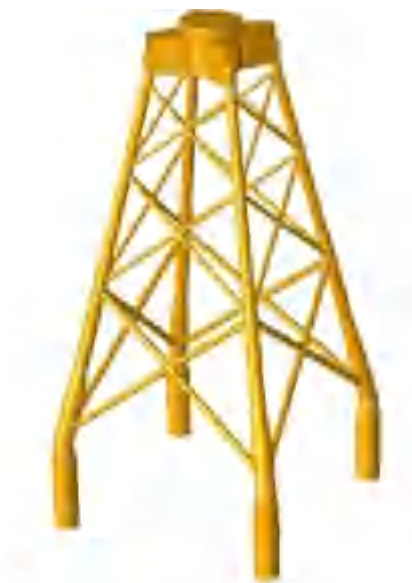
图 3.4-5b 导管架基础方案图
