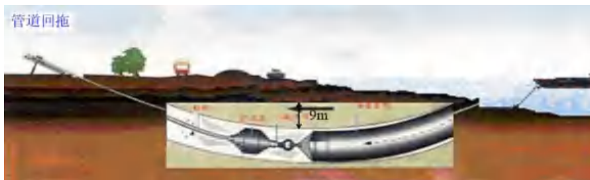
图 3.5-22c 定向钻施工工艺流程示意图
