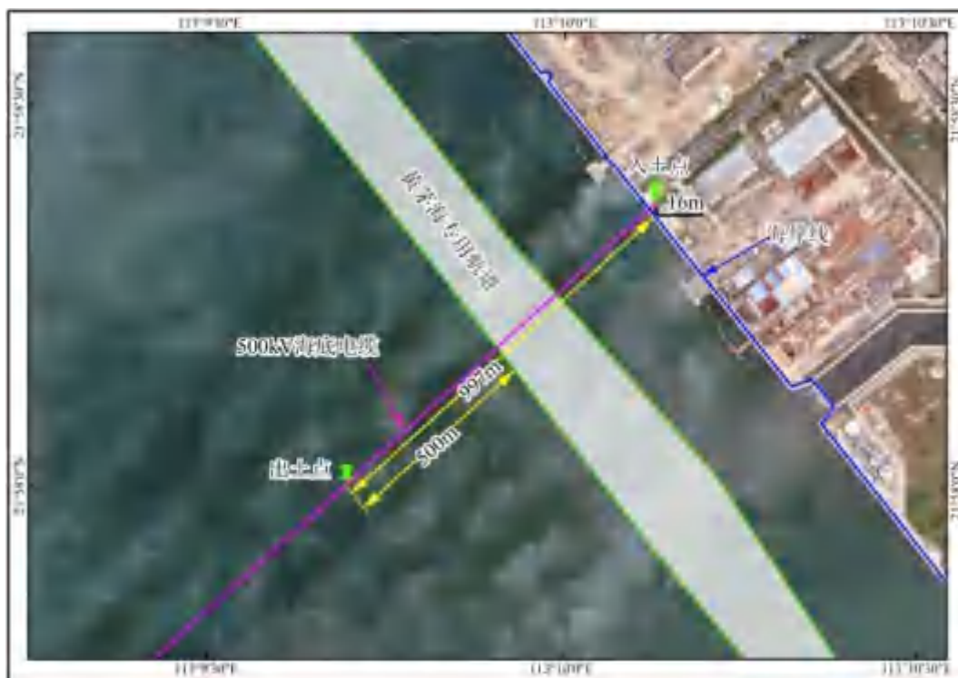
图 3.5-21a 海缆定向钻施工入土点位置示意图
