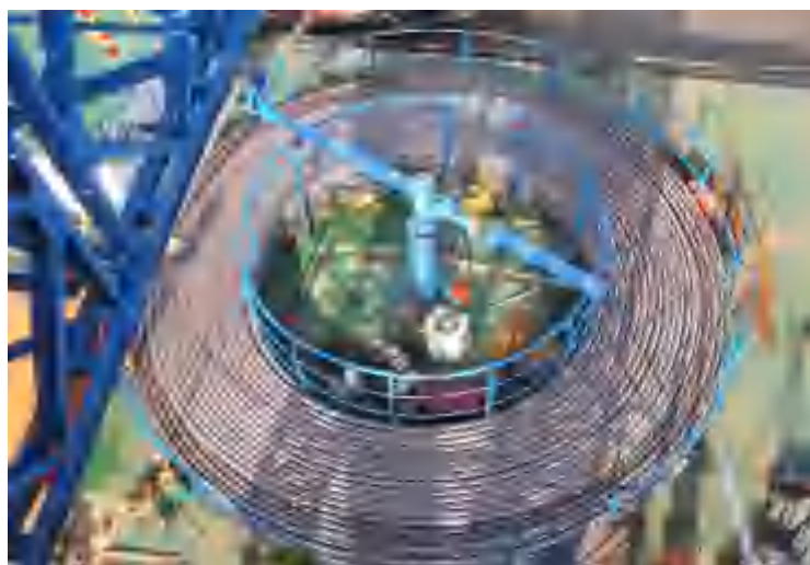
图 3.5-15 海缆装船示意图
